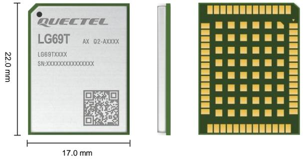
LG69T 系列是基于意法半导体第五代定位芯片研制而成的高精度 GNSS 定位模块。它可同时接收并追踪多个 GNSS 星座（GPS、GLONASS、Galileo 和 BDS）及 QZSS 的双频信号（L1 + L5 或 L1 + L2）。基于更高精度的双频原始观测量，结合 RTK（载波相位差分）技术，LG69T 系列可以在数秒内达到厘米级定位精度，极大提高设备的定位精度。
